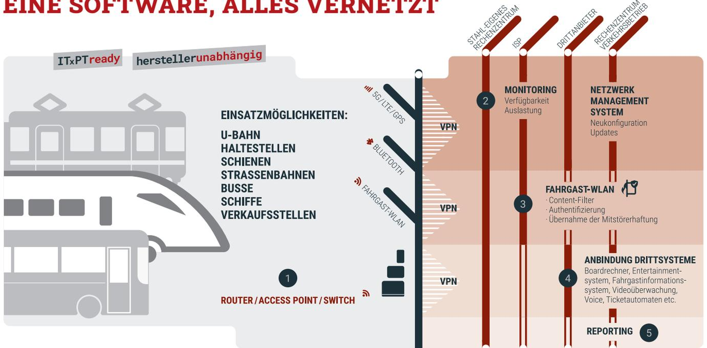
1 Router speziell ausgelegt für Betrieb in bewegten Fahrzeugen. Weniger Geräte, Antennen und eSIM-Karten und damit weniger Kosten.
